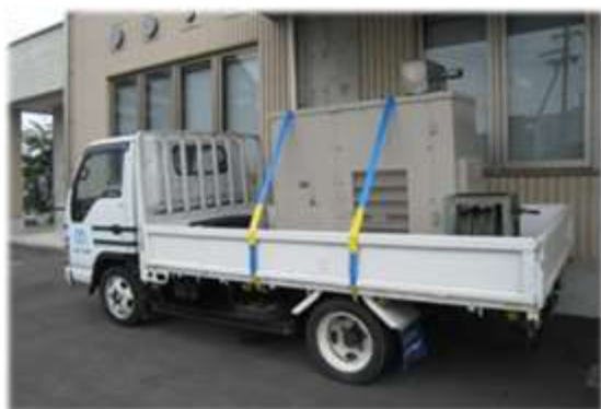
【可搬式自家発電設備】
